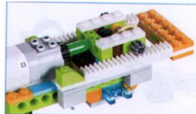
Для преобразования вращательного движения в поступательное.
